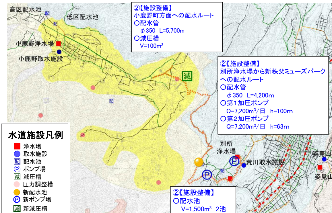
図 2-4 新秩父ミュージックパーク配水池の建設の概要
